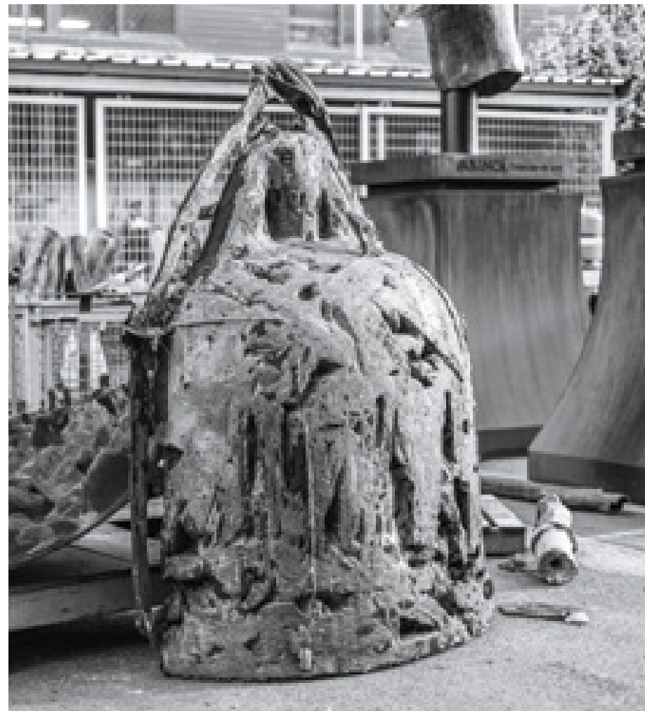
Démoulage, fonderie à Madrid, Espagne Unmoulding, foundry in Madrid, Spain
